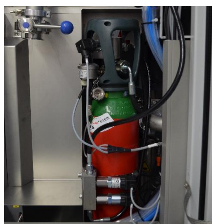
Fig. 33 Bottiglia per gas argon armadio di processo lato posteriore
