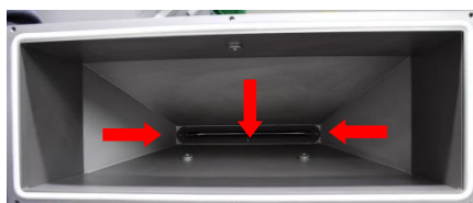
Fig. 137 Sensori del livello di riempimento serbatoio principale
