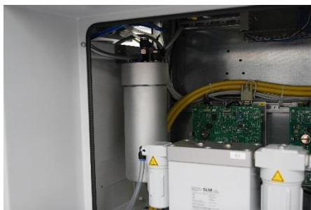
Fig. 134 Alloggiamento del filtro montato
