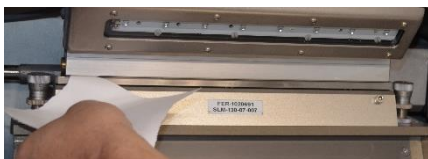
Fig. 102 Controllare la distanza guida del coperchio / tino di riempimento
