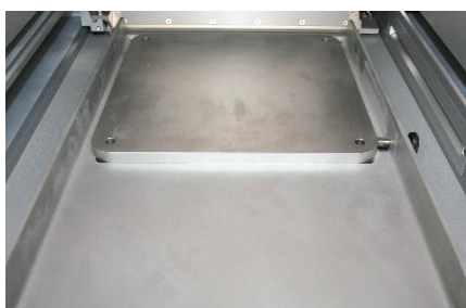
Fig. 91 Dispositivo di sollevamento con sistema di bloccaggio inserito
