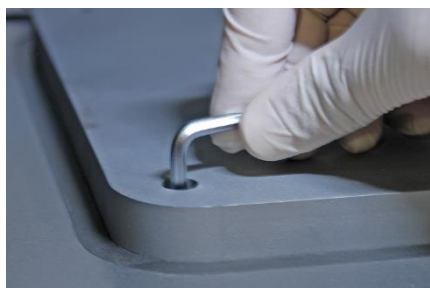
Fig. 73 Montaggio della piastra di substrato
