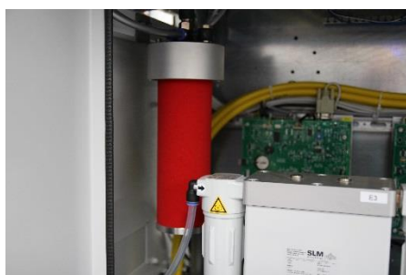
Fig. 133 Avvitare il nuovo elemento filtrante
