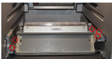
Fig. 125 Smontare il rivestitore
