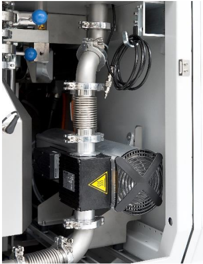
Fig. 25 Pompa di circolazione gas
