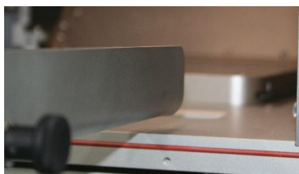
Fig. 89 Controllo altezza del dispositivo di sollevamento
