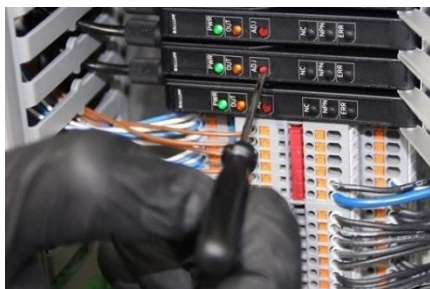
Fig. 140 Sensore del livello di riempimento attivo
