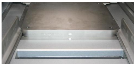
Fig. 90 Introduzione del dispositivo di sollevamento nelle scanalature della piastra di substrato
