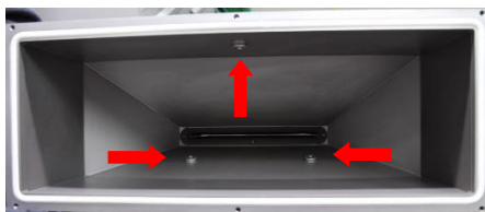
Fig. 142 Sensori del livello di riempimento superiori
