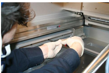
Fig. 131 Rimuovere le viti sulla custodia di uscita
