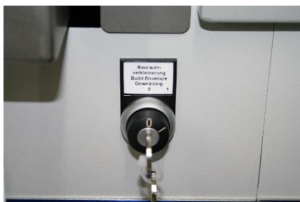
Fig. 9 Interruttore a chiave riduzione della camera di processo
