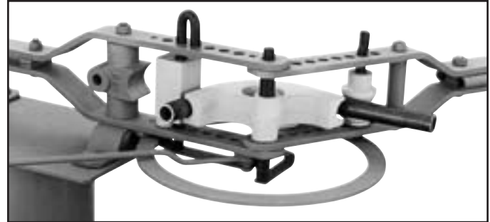
44B Rigid Conduit 90° Form Die bending 1" Conduit to a 5" radius
