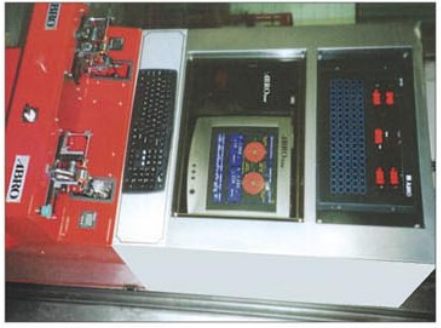
Semi-automatic machine for balancing small armatures. Machine semi-automatique pour l'équilibrage des petites armatures.
