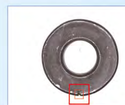
頭裂 Head Crack
