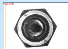
印記混料 Mark/ Material-Mix
