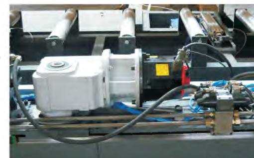
FANUC servo & Antriebstechnik gear FANUC全套伺服 + Antriebstechnik减速机
