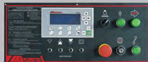
STANDARD CONTROL MSC400 for MSH series MSH系列标配 MSC400控制系统
