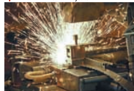
↑ Рис. 5. Сварка пил в кольцо
