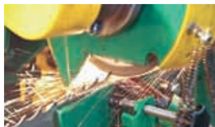
↑ Рис. 3. Заточка пил полнопрофильным кругом
