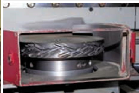
На фугоальной фрезе p-System хорошо видны резцы, расположенные под углом 70° к оси инструмента
