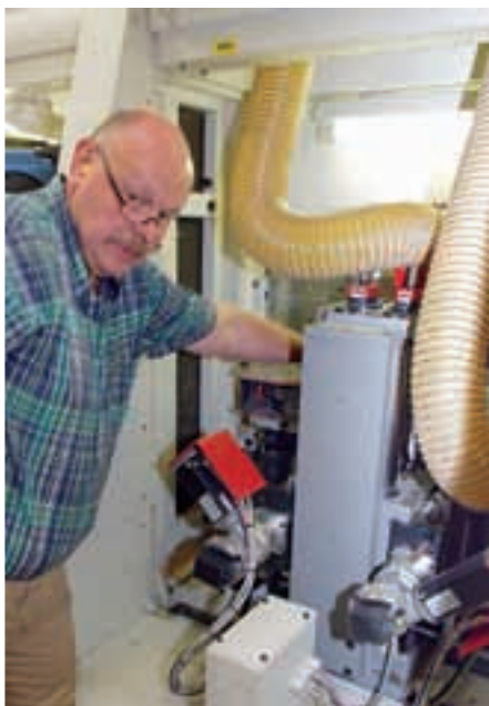
Обычно по требованиям техники безопасности вращающийся инструмент закрыт звуко- и пылезащитным кожухом. Юрген Нолл открывает кожух станка для демонстрации фрез p-System. В станках установлены сразу две фрезы p-System: для обработки панелей ДСП толщиной 16 и 19 мм
