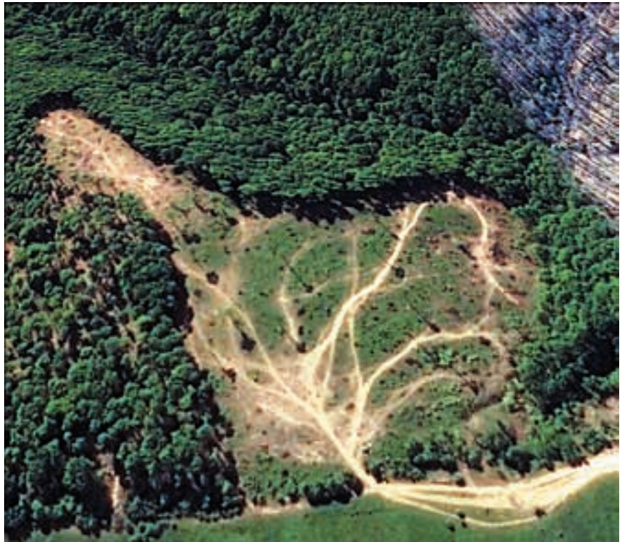
↑ Рис. 1. Общий вид лесосеки, разработанной с использованием наземной трелевки
