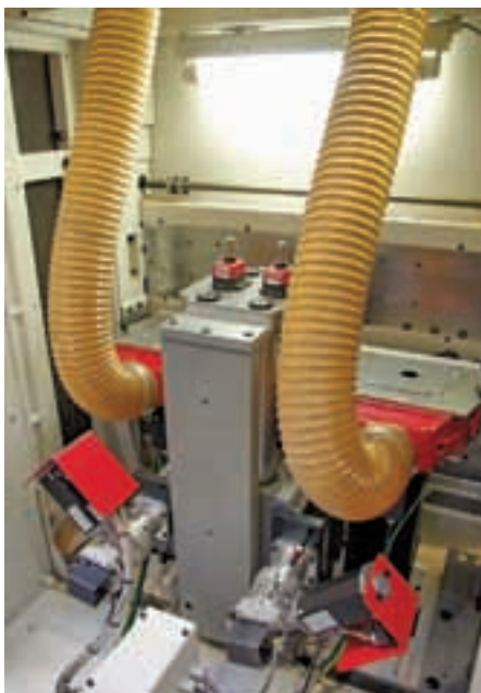
Обычно по требованиям техники безопасности вращающийся инструмент закрыт звуко- и пылезащитным кожухом. Юрген Нолл открывает кожух станка для демонстрации фрез p-System. В станках установлены сразу две фрезы p-System: для обработки панелей ДСП толщиной 16 и 19 мм
