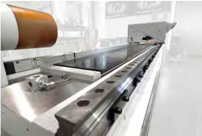
Dinomax equipaggiata con motori lineari su asse longitudinale
