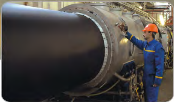
©正在俄罗斯运行中的PE Φ1600生产线 PE Φ1600 pipe extrusion line running in Russia
