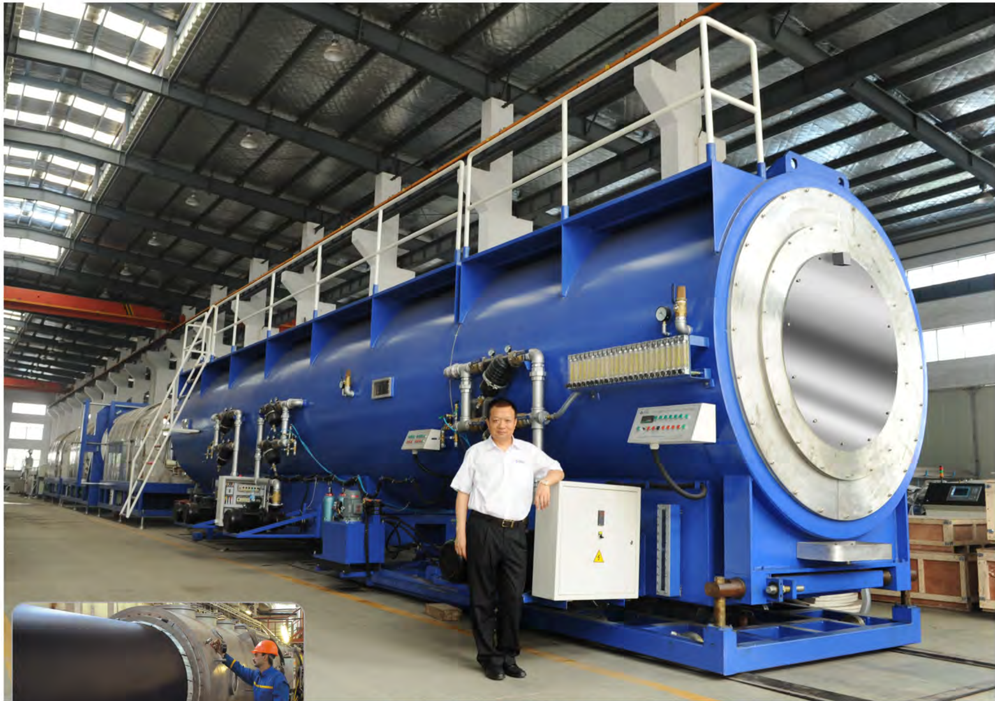
正在菲律宾运行中的PE Φ2000生产线 PE Φ2000 pipe extrusion line running in Philippines
