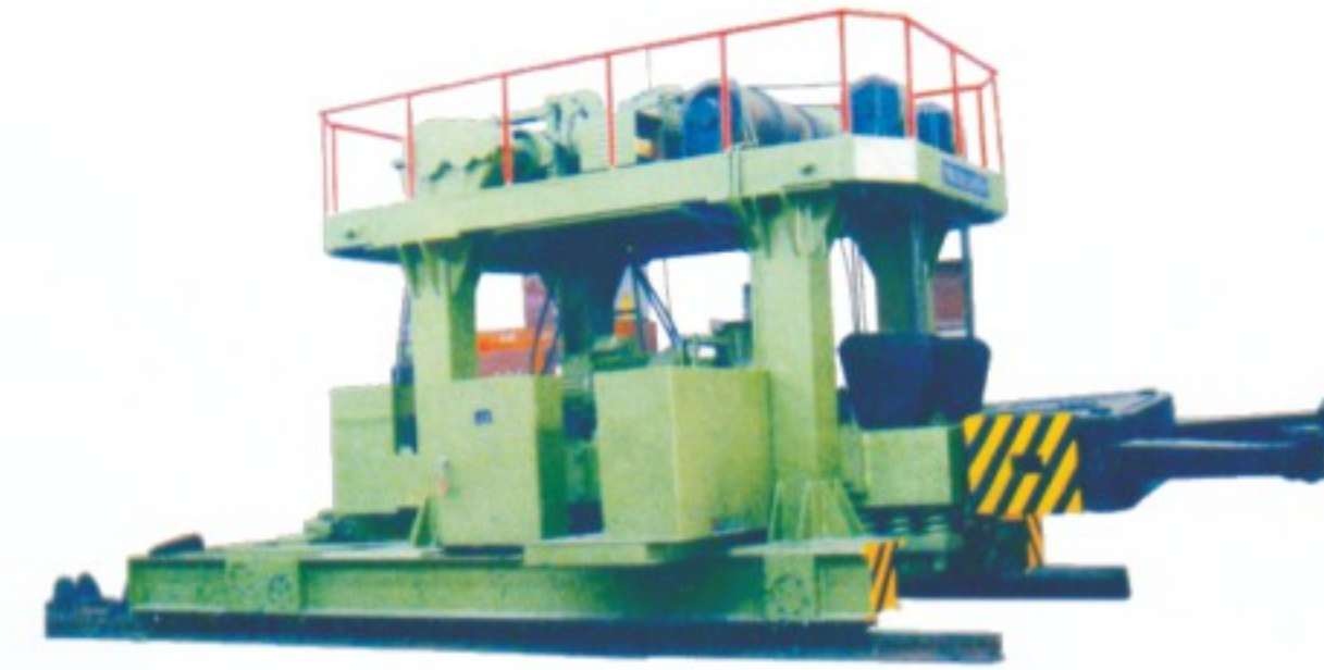
机械液压混合操作机 Mechanical-hydraulic mixed manipulator
