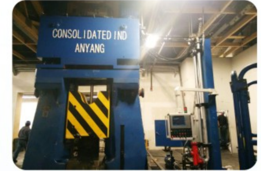
31.5KJ、80KJ、125KJ、160KJ等4台 数控锤在美国锻造航空锻件 31.5KJ、80KJ、125KJ、160KJ etc 4 sets of CNC forging hammers forge aviation forgings in USA
