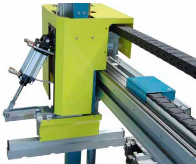
Pinza di presa pezzo inclinabile per evacuazione degli sfridi dall'interno del tubo Tilting piece-taking clamp for ejecting scraps from the inside of the tube
