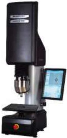
**Durómetro Rockwell Automático**
