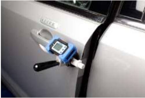
Medidor de Esfuerzo de Cierre
