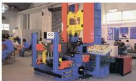
Стан предназначен для сборки, сварки, правки деформаций «грибовидности» и «саблевидности» двутавровой балки. Это одно из самых недорогих решений позволяющее на небольших площадях производить двутавровую балку отличного качества. Данная машина заменяет собой три станка – предварительной сборки на точечной сварке, станок сварки под флюсом и станок правки грибовидности.
