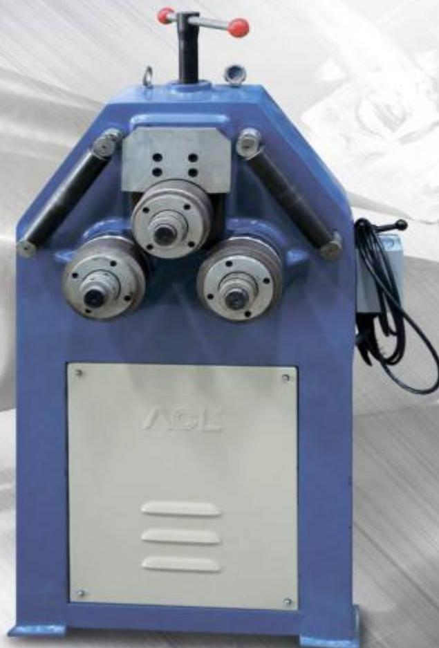
Трёхвалковые профилегибочные станки имеют три рабочие оси. По бокам станка установлены вспомогательные ролики для контроля за ходом детали и пропорциональной гибки. В комплекте идут ролики для гибки уголка с регулируемым зазором под толщину материала.
