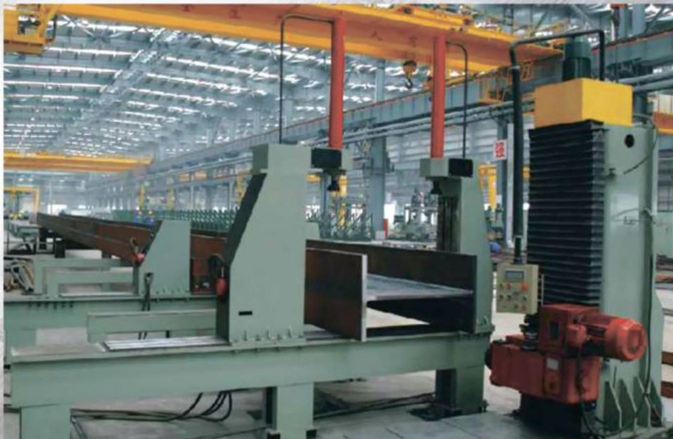
Данное оборудование используется для обработки торцов металлоконструкций под углом 90 градусов. Станок состоит из стола, на котором устанавливается изделие и фрезерной головки с вертикальными и горизонтальными направляющими хода. Изделие укладывается на стол и фиксируется зажимами. После этого торец обрабатывается фрезой с твердосплавными резцами.
