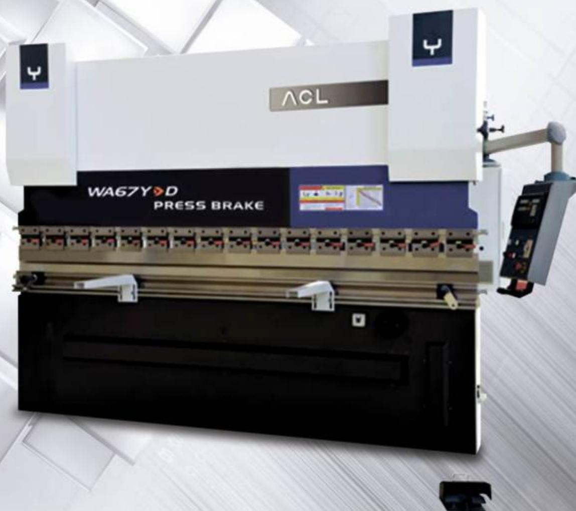
Гибочные пресса серии WA67 предназначены для изготовления деталей невысокой сложности. Для работы на прессах этой серии не требуется дополнительного обучения оператора. Рабочие параметры вводятся вручную, оператор задает значения по осям X, Y, для этого понадобится лишь несколько секунд, и пресс готов к работе.
