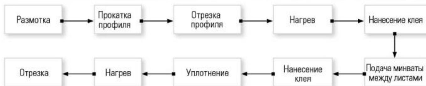
Данная производственная линия предназначена для изготовления стеновых и кровельных сэндвич-панелей с двумя видами наполнителя: полистиролом (EPS) и минеральной ватой. Линия обеспечивает полный производственный процесс и рассчитана на объём производства 120 - 250 сэндвич-панелей в смену, при 8-часовом рабочем дне, длине панели 6 м.
