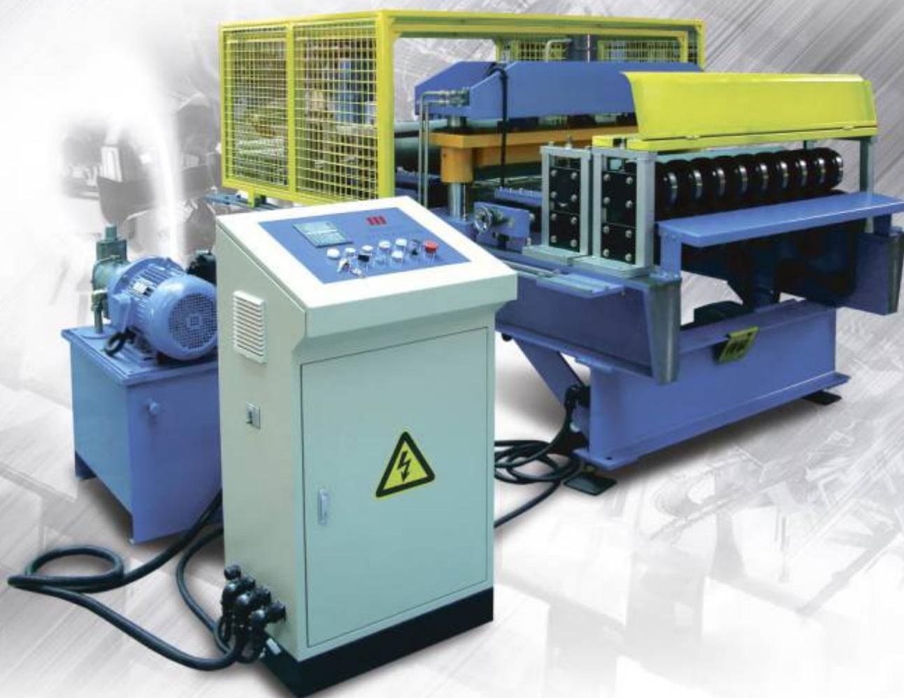
Линия предназначена для резки стальных листов и рулонного металла на полосы фиксированной длины.
