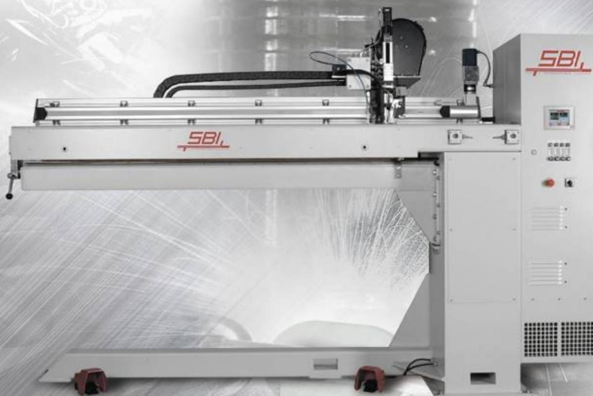
Высокое качество сварки – малая зона термического влияния; узкий, равномерный по ширине шов, минимальное коробление, глубокое проплавление, отсутствие включений вольфрама в металле.
