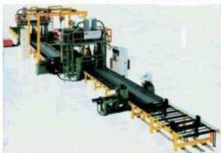
Установка горизонтальной сварки включает в себя несколько основных агрегатов собранных в компактную линию:
