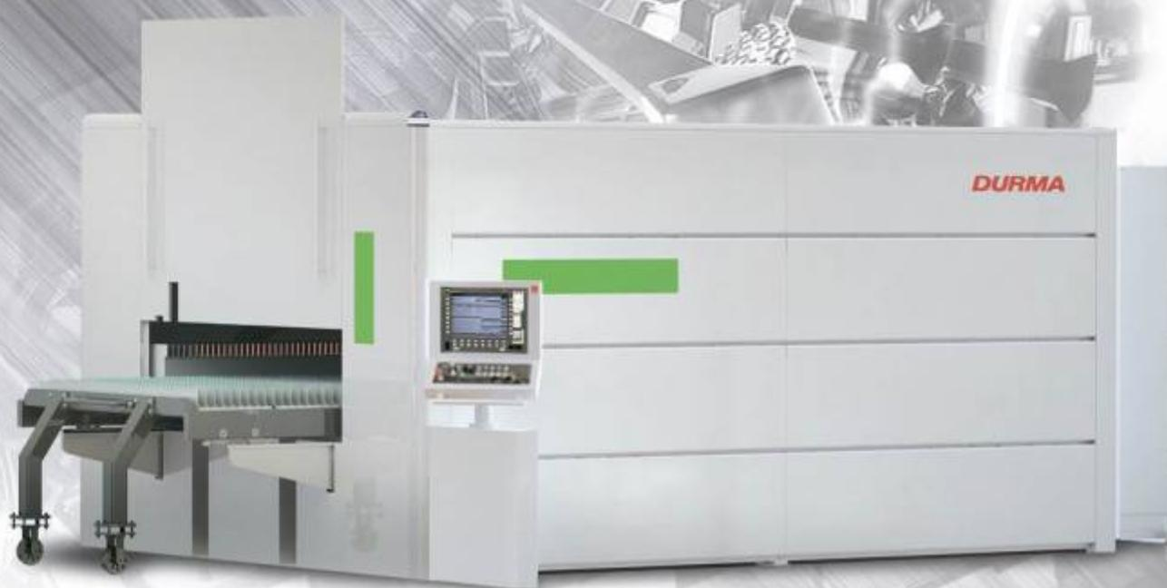
Станки DURMA моделей HD-F / HD-FL представляют собой высокоскоростную 2-D систему лазерной резки плоского листового металла. Она работает по принципу «плавающей оптики». Это значит, что заготовка для обработки находится на столе резки и лазерная головка перемещается по осям X и Y. Такой тип конструкции позволяет достичь максимально высоких значений ускорения и благодаря датчику прямого измерения максимальной точности геометрических размеров детали.
