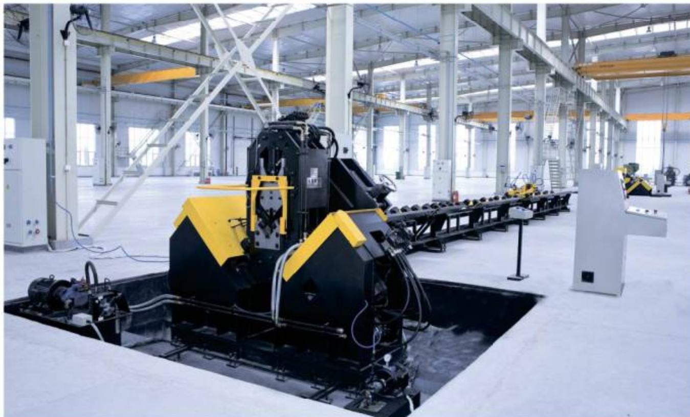
Линия обеспечивает сверление под болтовое отверстие, маркирование и рубку уголка в размер по спецификации импортированной из чертёжной программы в ЧПУ линии.
