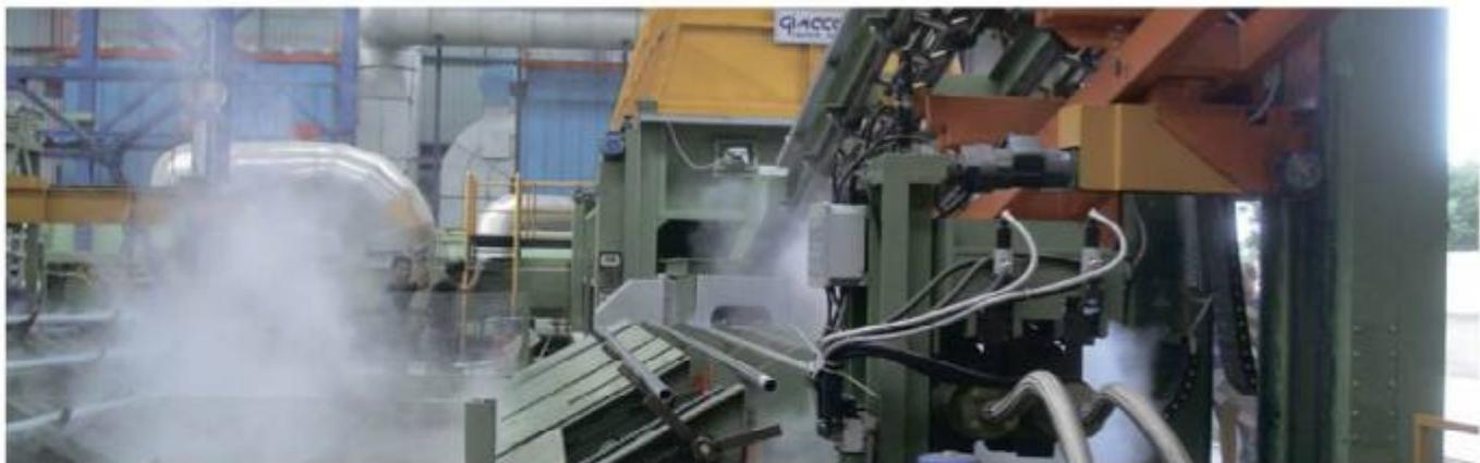
Полная автоматическая линия оцинковки труб. Автоматическая оцинковка, основанная на "рецептах" и контролируемая местным и удаленным компьютером. Предельно лимитированное вмешательство операторов только для изменения размеров колец внутренней и внешней продувки. Всего 3 оператора могут производить до 1100 труб или 25 тонн труб в час. Оборудование подходит для труб длиной от 4 до 9,5 метров. Полуавтоматические линии с поддержкой оператора для квадратных и прямоугольных труб.
