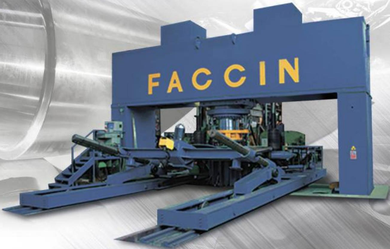
Для выбора правильного размера пресса нужно рассчитать размер развертки наибольшего днища. После этого можно решить вопрос о расстоянии между колоннами. Усилие пресса связано с прочностью обрабатываемого материала и с требуемым рабочим циклом. Чем больше имеющаяся сила, тем меньше время, нужное для прессования, поскольку можно обрабатывать лист большими штампами, уменьшая количество ходов, требуемых для формирования днища.
