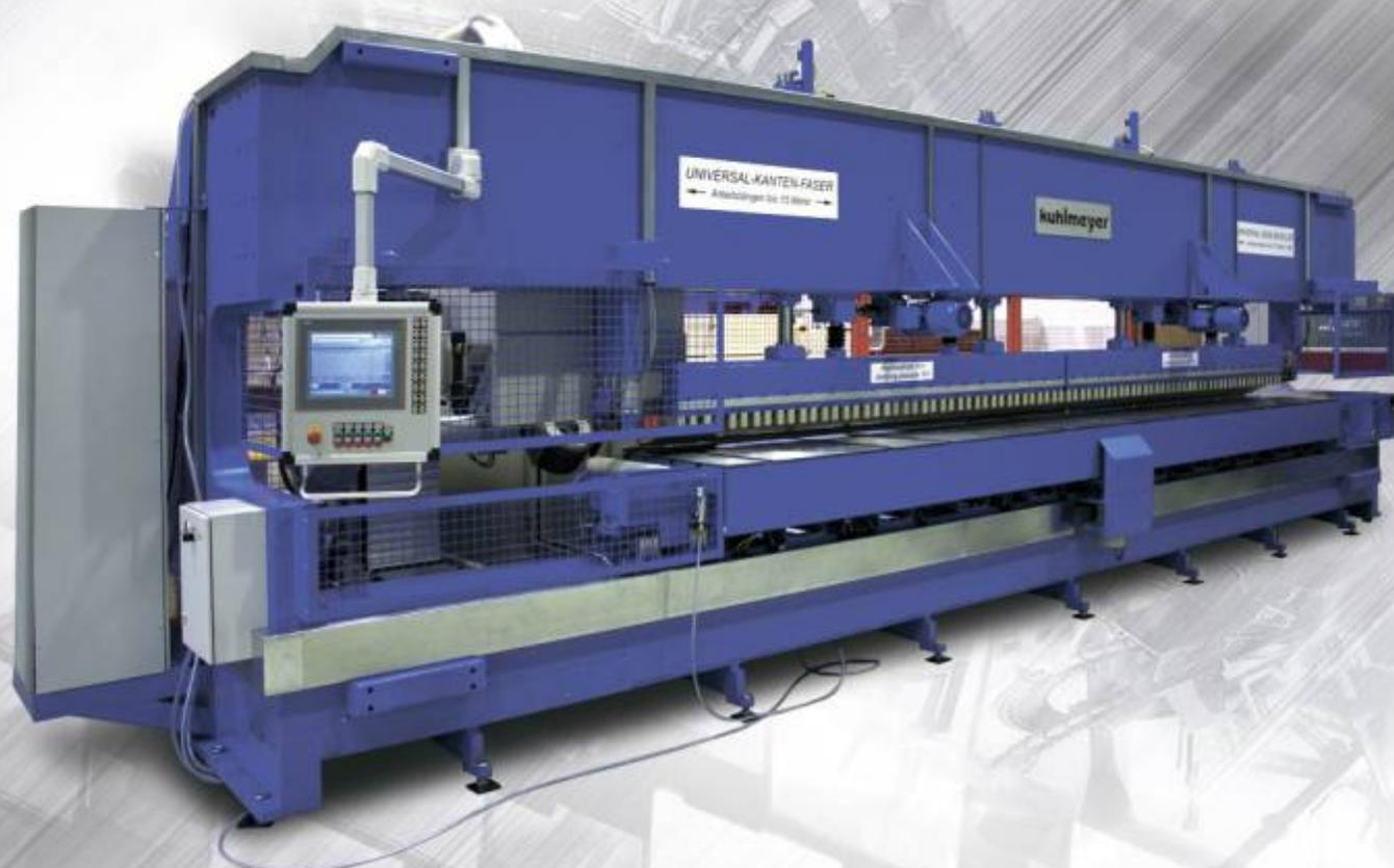
Станок используется как для выравнивания кромки листа, так и для обработки кромки под углом. Обрабатываемый лист зажимается гидравлическими прижимами.
