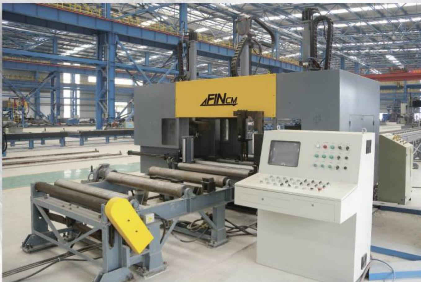
Станок предназначен для резки двутавровых балок, швеллеров, их полков и стоек. Рама станка собрана из продольных и поперечных балок и имеет жесткую конструкцию. Сверху имеется портал с суппортом, на котором размещена газовая горелка, перемещаемая вверх-вниз, вправо-влево и способная резать в вертикальной плоскости. Станок оснащен: устройством автоматического обнаружения заготовки, автоматическими зажимами, толкателем, электронным устройством поджига горелок, ЧПУ.
