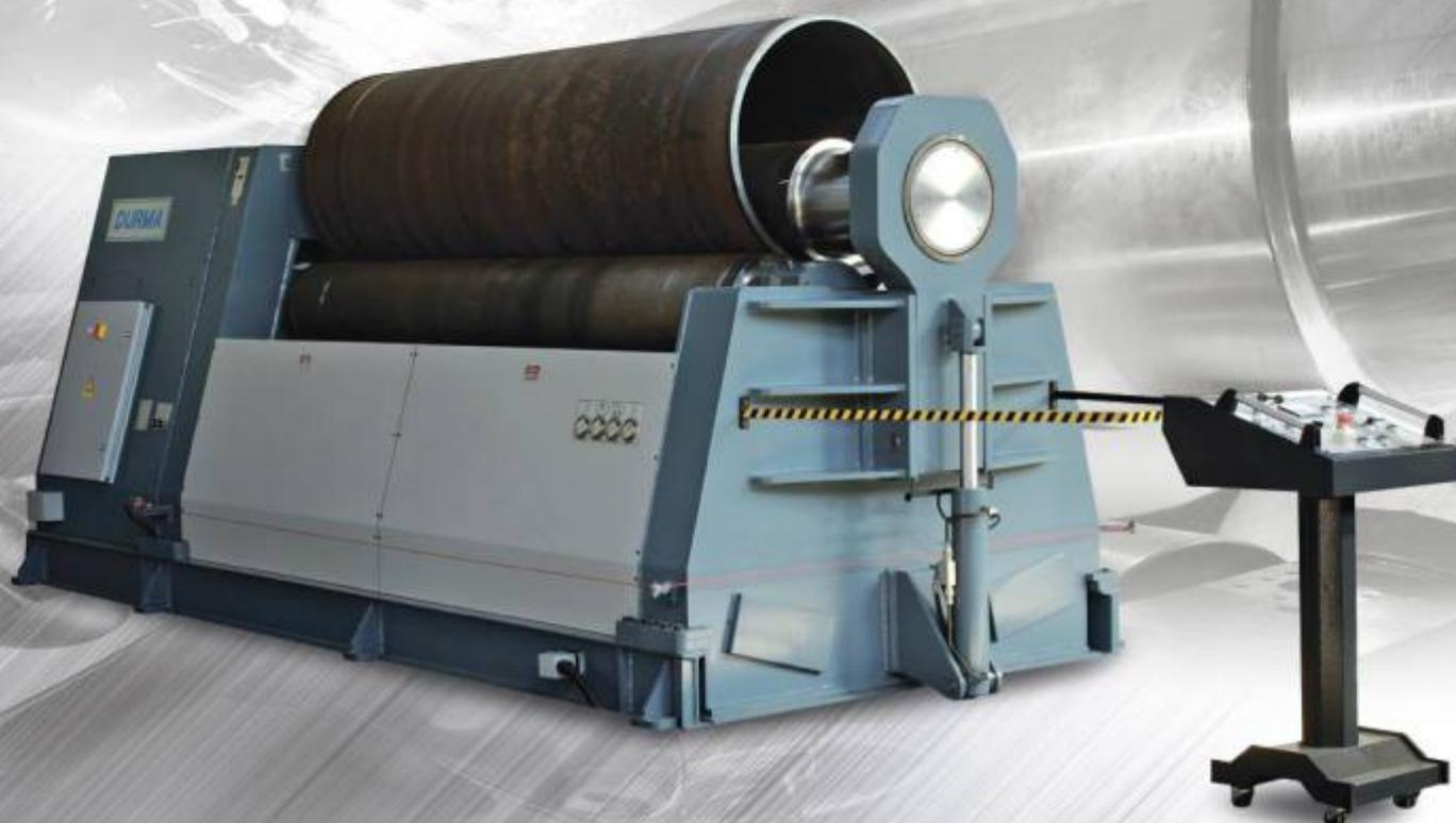
Станок выполнен с учетом требований безопасности ЕС. По специальному запросу станки могут быть выполнены с различными техническими характеристиками. Опционально могут комплектоваться усиленными валами, профилегибочными роликами и электронным устройством считывания положения заготовки, системой плавной регулировки рабочей скорости, нижней и верхней поддержкой заготовки с гидравлическим приводом, а так же взаимозаменяемым верхним валом.
