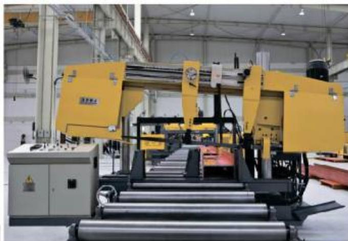
Ленточнопильный станок модели BS предназначен как для одиночной работы, так и для использования в составе промышленных линий. Зачастую данный станок комплектуется совместно со моделью SWZ (в том числе по CNC управлению), что дает расширенные возможности по обработке металлоконструкций.
