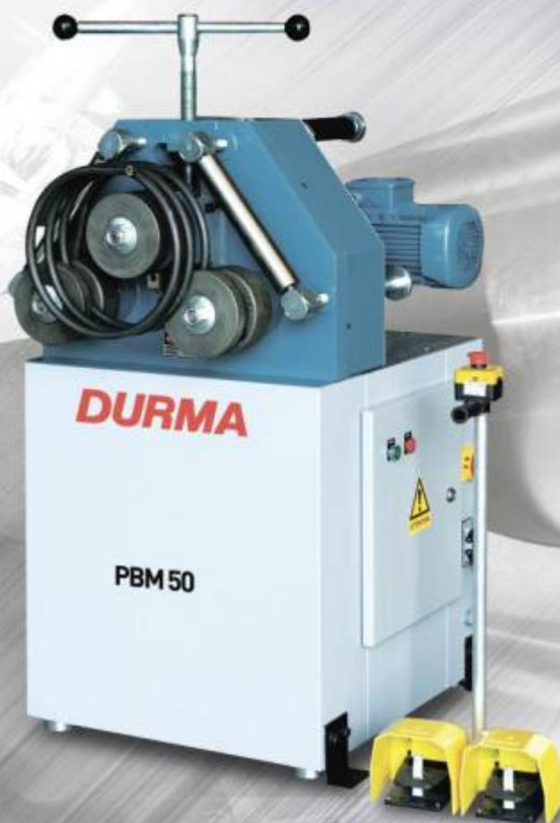
Прочная рама станка представляет собой особо прочную стальную конструкцию, обработанную после сварки для жесткости. Точная гибка с валом и подшипниками большого диаметра снижает отклонения. Короткое время цикла достигается высоким крутящим моментом и скоростью.
