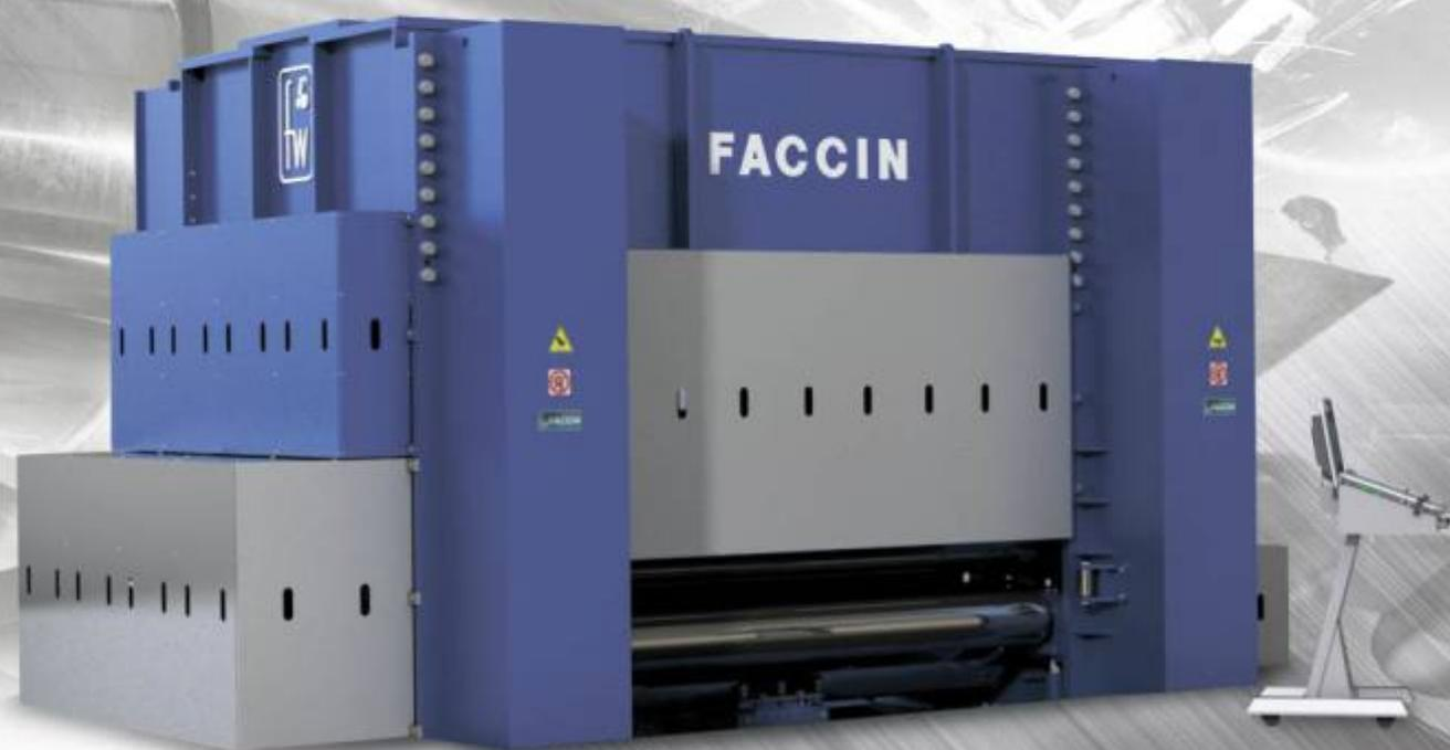
Эти машины, в первую очередь, рассчитаны для правки толстого листа больших размеров. Станок оснащен 7-ю или 9-ю рабочими валками, каждый из которых оснащен 14-ю дополнительными поддерживающими валками, и 2 подающими валками.
