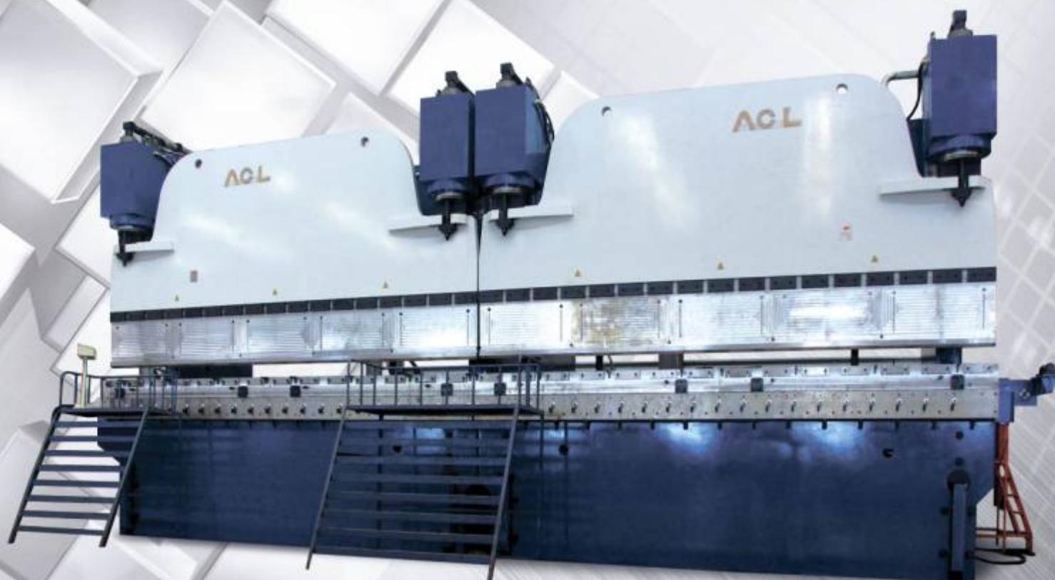
W67K – с CNC контроллером, контролирующим опционально до 12 осей и отображающим весь процесс гибки в 2D или 3D графическом изображении. Гибочные пресса серии W67K предназначены для изготовления сложных изделий, имеющих несколько гибов в разных плоскостях. Гибочные пресса W67K комплектуются системой компенсации прогиба стола.
