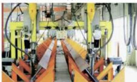
Данная линия состоит из трех основных отдельных станков – сборочный станок, сварочный портал для сварки балок в положении под наклоном в 45 градусов, стан для правки деформаций после сварки.
