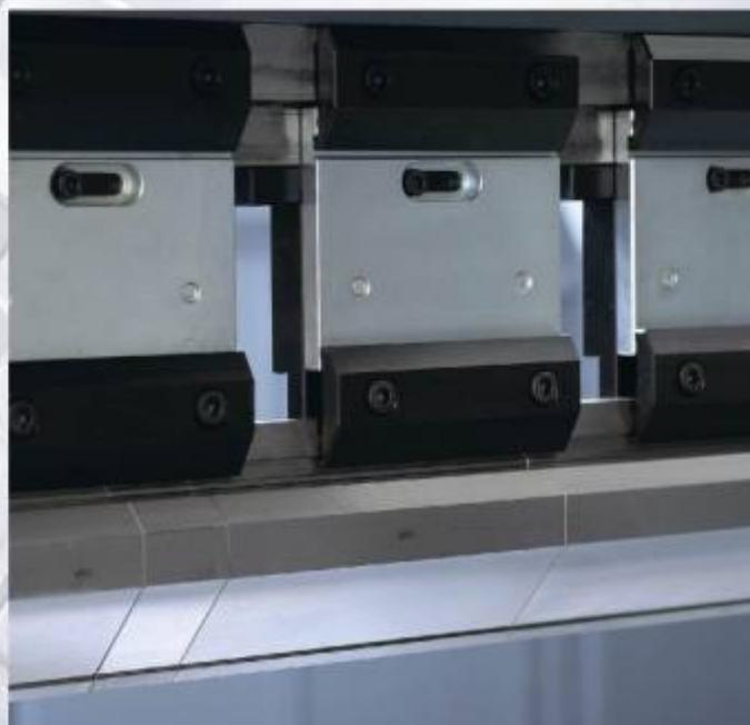
Прессы ведущих европейских компаний, широко производится с применением самых передовых технологий с использованием стали высокого качества марок 42CrMo4 или C45. Инструмент проходит механическую обработку с точностью 0,01 мм, а также индукционную закалку и лазерную закалку до достижения максимальной твердости рабочей поверхности. Все это значительно увеличивает срок службы инструмента, а так же точность обработки деталей.
