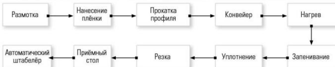
Данная производственная линия предназначена для изготовления стеновых и кровельных сэндвич-панелей с двумя видами наполнителя: полиуретаном и минеральной ватой. Линия обеспечивает непрерывный производственный процесс и рассчитана на объём производства до 600 сэндвич-панелей в смену (до 3300 м<sup>2</sup> в смену).
