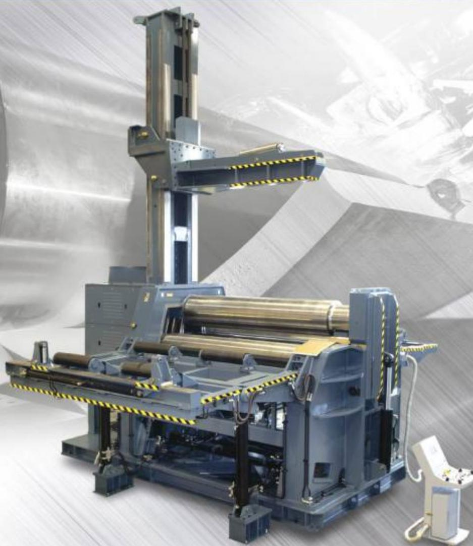
Вальцы листогибочные четырехвалковые гидравлические HRB 4 - это станки с увеличенной производительностью. Вальцы позволяют с легкостью производить предварительный подгиб и конический изгиб заготовки, а также двойной предизгиб на обоих концах листа.
