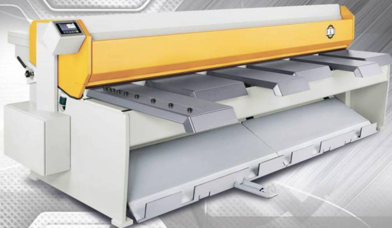
Промышленная гильотина для металла RAS серии PRIMECUT обладает всеми качествами, необходимыми для современной металлообработки. Рабочая длина гильотины - 3100 мм, позволяет производить резку металлического листа толщиной до 3,0 мм. Инновационная технология «качающейся балки» дает ровный и правильный рез металлического листа. Величина угла реза менее 1 градуса, что позволяет получать узкий штрипс без скручивания. Специальные лезвия режущей балки идеальны для мягкой стали и нержавеющей.
