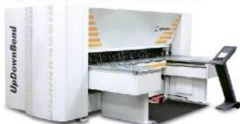
Выполняют операции гибки металлического листа толщиной до 6 мм и длиной до 3 м. Гидравлические гильотинные ножницы с автоматической установкой заднего упора производят резку листового металла длиной 3 м и толщиной до 13 мм.
