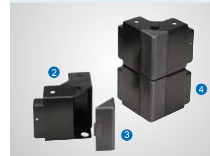
■拆卸式底座 1.每個獨立腳座皆可承受1800kg以上，絕不變形。 2.每個腳座皆有調整水平高低，並從外側固定於地面之功能。 3.塑製護蓋，美觀大方。 4.高度為100mm，可堆疊，視需求增加高度。 Patent independent adjustable base set 1.Each single corner base with load capacity of 1800kg without distortion 2.Adjustable outwards in accordance with actual horizontal level 3.Pretty plastic protecting cover 4.100mm height for each base set, able to be piled if needed
