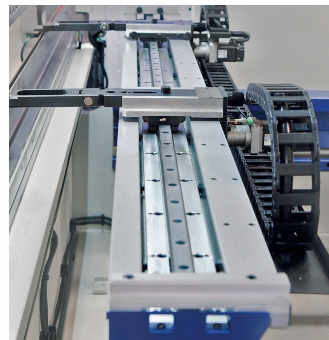
Eje Z1/Z2. Posicionamiento Lateral Automático de los Dedos-Topo (Estándar en Serie ELITE PRO)
