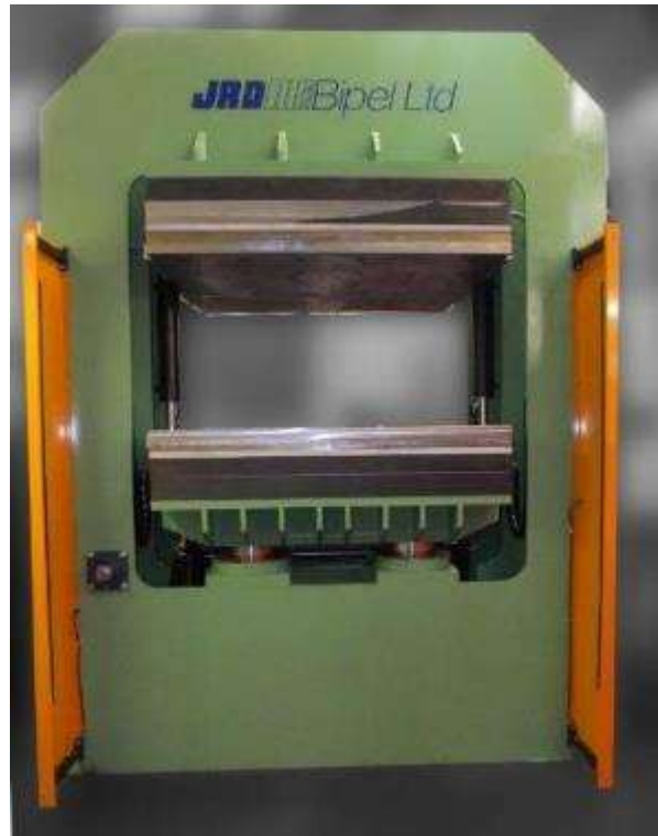
200 kN Rubber Moulding Press
