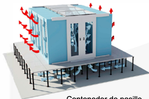
Contenedor de pasillo Aire frío
