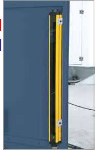
Ön Işık Bariyerli Parmak Koruma Sistemi Front Light Guard Finger Protective System
