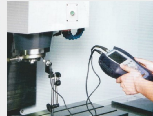
▲ 在线平衡调试 Online dynamic balancing test
