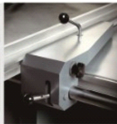
滑尺进给装置 minim device of guide rule
