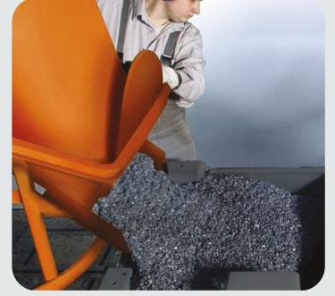
Mineral Döküm Gövde Mineral Casting Body
