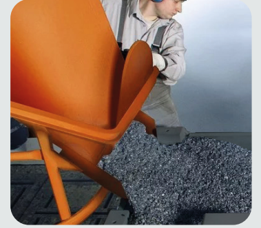
Mineral Döküm Gövde Mineral Casting Body
