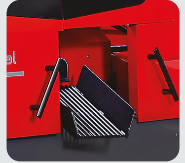
Otomatik Uç Kesim Ayırma Kızağı Automatic Scrap Separator
