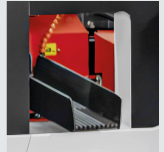
Otomatik Üç Kısım Ayırma Kızağı Automatic Scrap Separator
