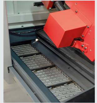
Paletli Tip Talaş Konveyörü Pallet-Type Chip Conveyor
