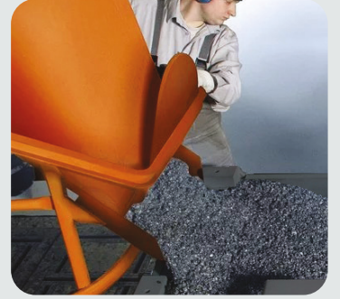
Mineral Döküm Gövde Mineral Casting Body
