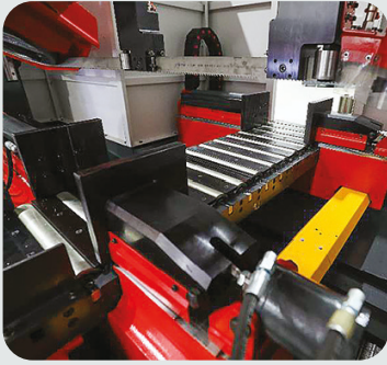
Servo Malzeme Sürme Sistemi Servo Controlled Feeding Vise
