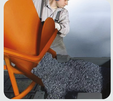
Mineral Döküm Gövde Mineral Casting Body
