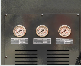
Ayarlanabilir Mengene Basıncı Adjustable Vise Pressure
