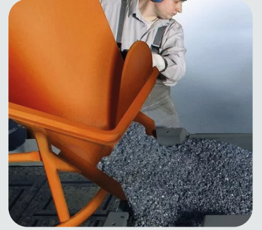
Mineral Döküm Gövde Mineral Casting Body
