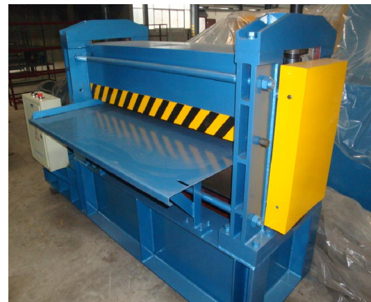
--aluminum sheet embossing machine --1250mm width, 0.5-0.6mm --FOB Ningbo 15671.00/set
