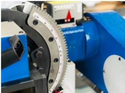
角度调节机构 Angle adjusting mechanism
